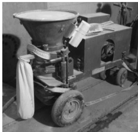
Рисунок 1: установка для набрызга MEYCO® Piccola с противопылевым фильтром
