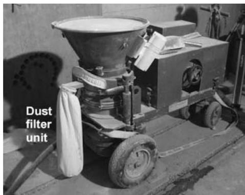
Машина для сухого метода торкретирования серии Meuso Piccola или аналогичное набрызгбетонное оборудование должны быть оснащены фильтром для коллектора грязи или аналогичной грязесборной системой, как показано ниже, см. рис.
